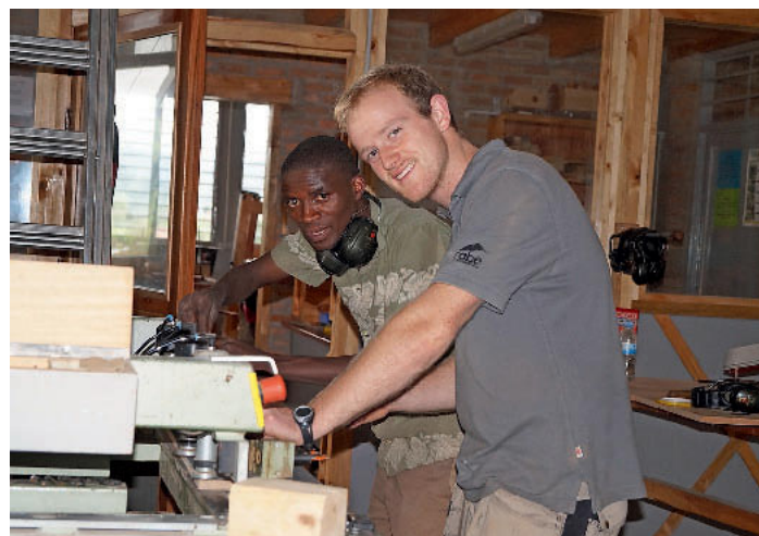
! Moses, der Verwalter des Werkzeug- und Zubehörmagazins, setzt mit Felix Rabe einen Dübelautomaten zum wirtschaftlichen Bohren von Lochreihen in Gang.
